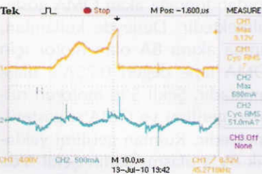
Şekil 6. Rulmanda dielektrik delinme durumu, rulman gerilimi (sarı, 4V/bölme), OMA (mavi, 0.5A/bölme), 10µs/bölme
